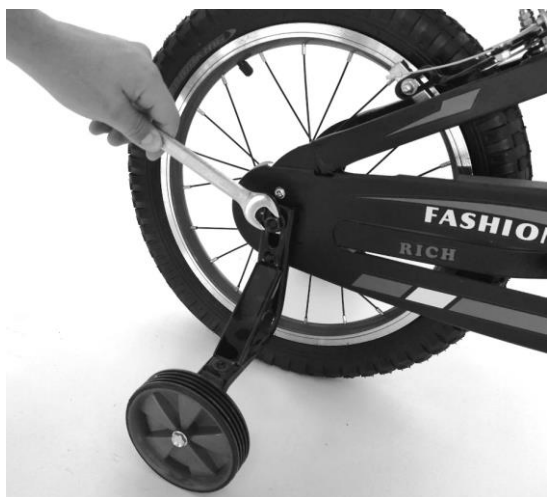
3. Scoateti piulitele cu ajutorul unei chei de 15.
