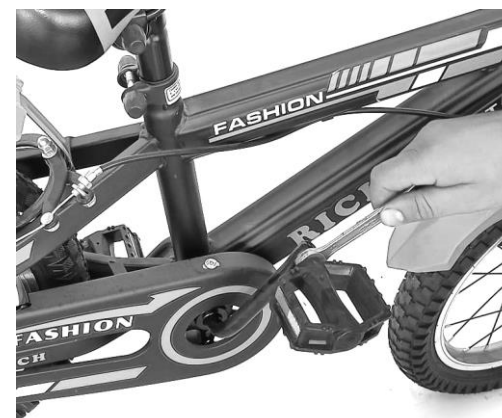
5. Insurabati pedalele cu ajutorul unei chei de 15, tinand cont de marcajele din interiorul filetelui. R=dreapta, L=stanga.
